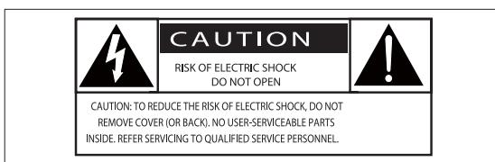
Значок молнии указывает на наличие неизолированных материалов в устройстве и опасность поражения электрическим током. В целях безопасности не снимайте корпус. Восклицательный знак указывает на функции, перед использованием которых необходимо внимательно ознакомиться с прилагаемым руководством во избежание последующих проблем с работой и обслуживанием устройства.
